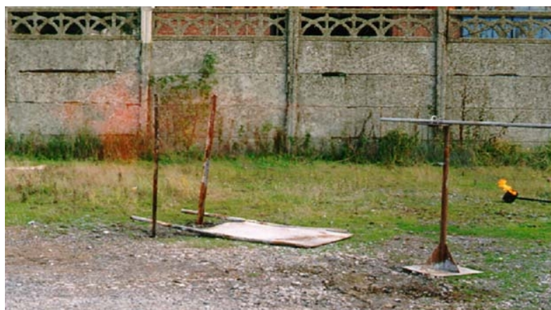
FIGURE 2.2 – Photo d'une flamme d'hydrogène, particulièrement dangereuse pour les équipes d'intervention puisque peu visible à l'œil nu.
